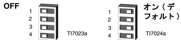
図 . 7. DIP スイッチ (SW2) 設定
