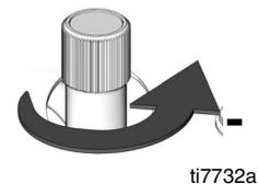
8. Pulse el motor
