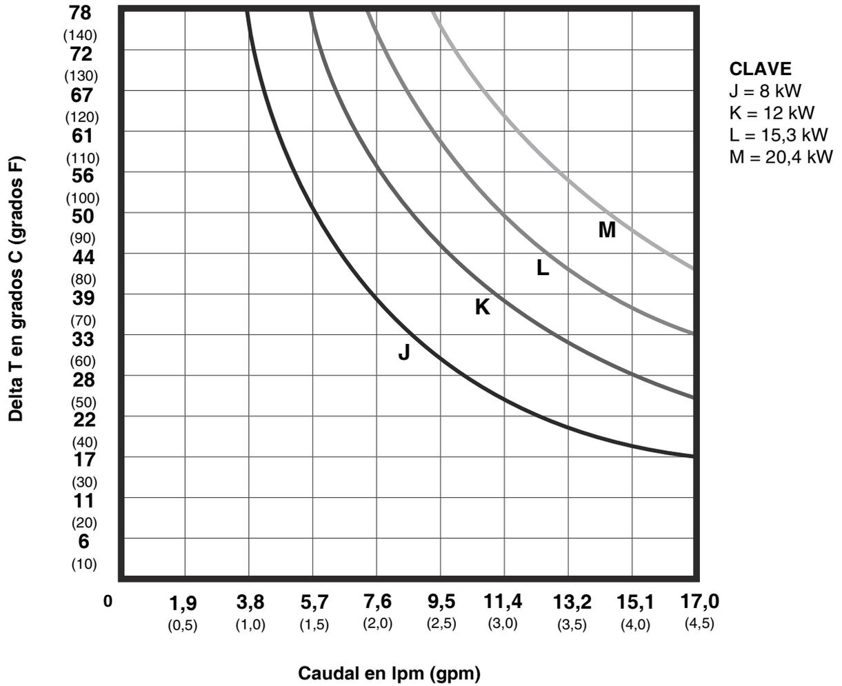
★ Los datos de rendimiento del calentador se basan en pruebas con aceite hidráulico 10 wt. y 230 V en los cables de potencia del calentador.
