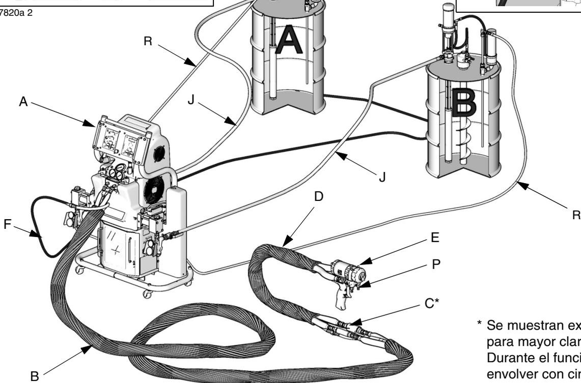
\* Se muestran expuestos para mayor claridad. Durante el funcionamiento, envolver con cinta adhesiva.
