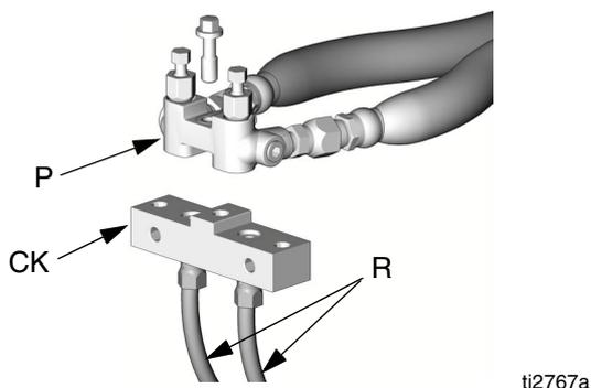
2. Encamine las líneas de recirculación de vuelta hasta los bidones de suministro de los componentes A o B respectivos. Utilice mangueras clasificadas para la presión máxima de trabajo de este equipo. Vea **Instalación típica, sin circulación**, página 15.
