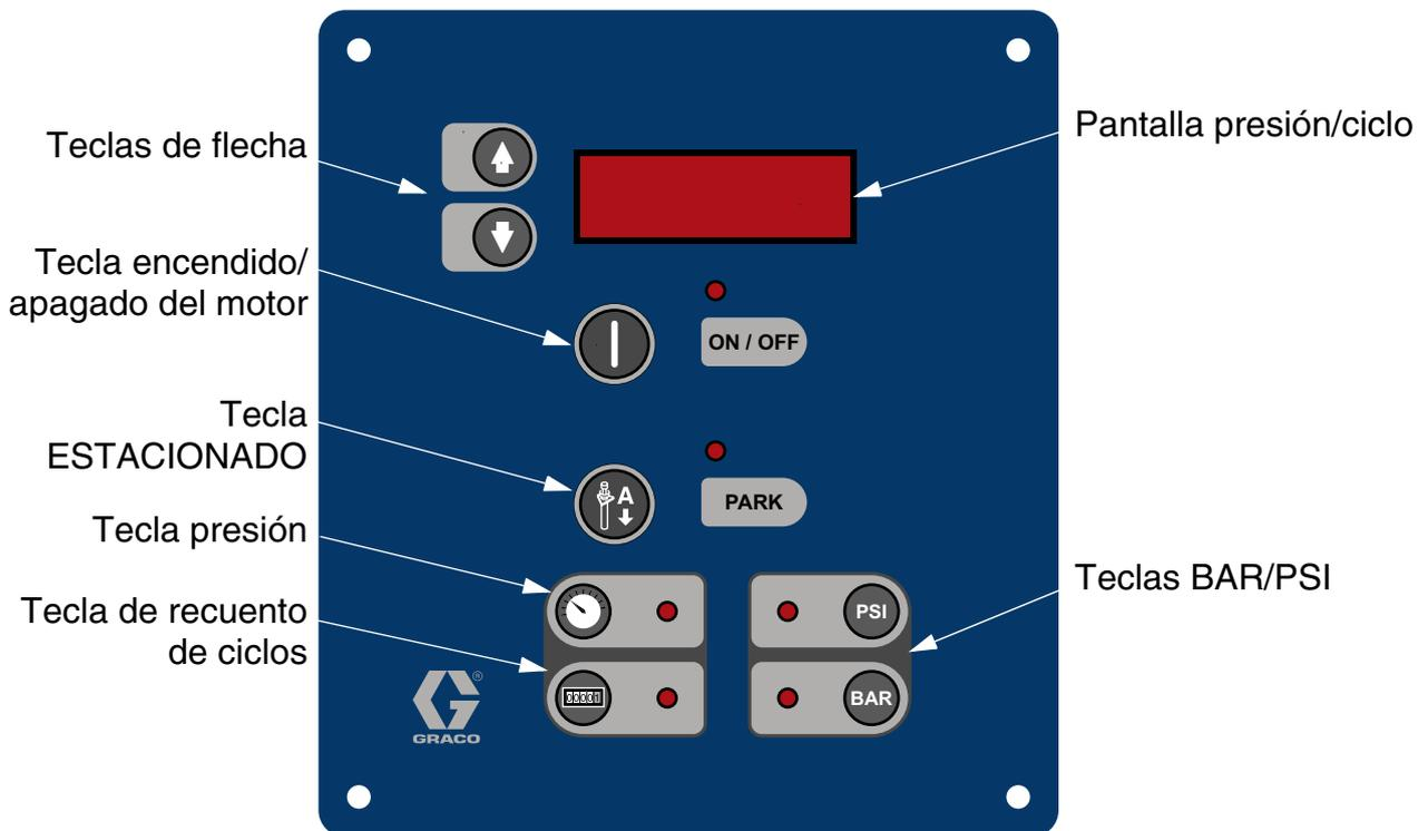
FIG. 5. Controles e indicadores del motor
