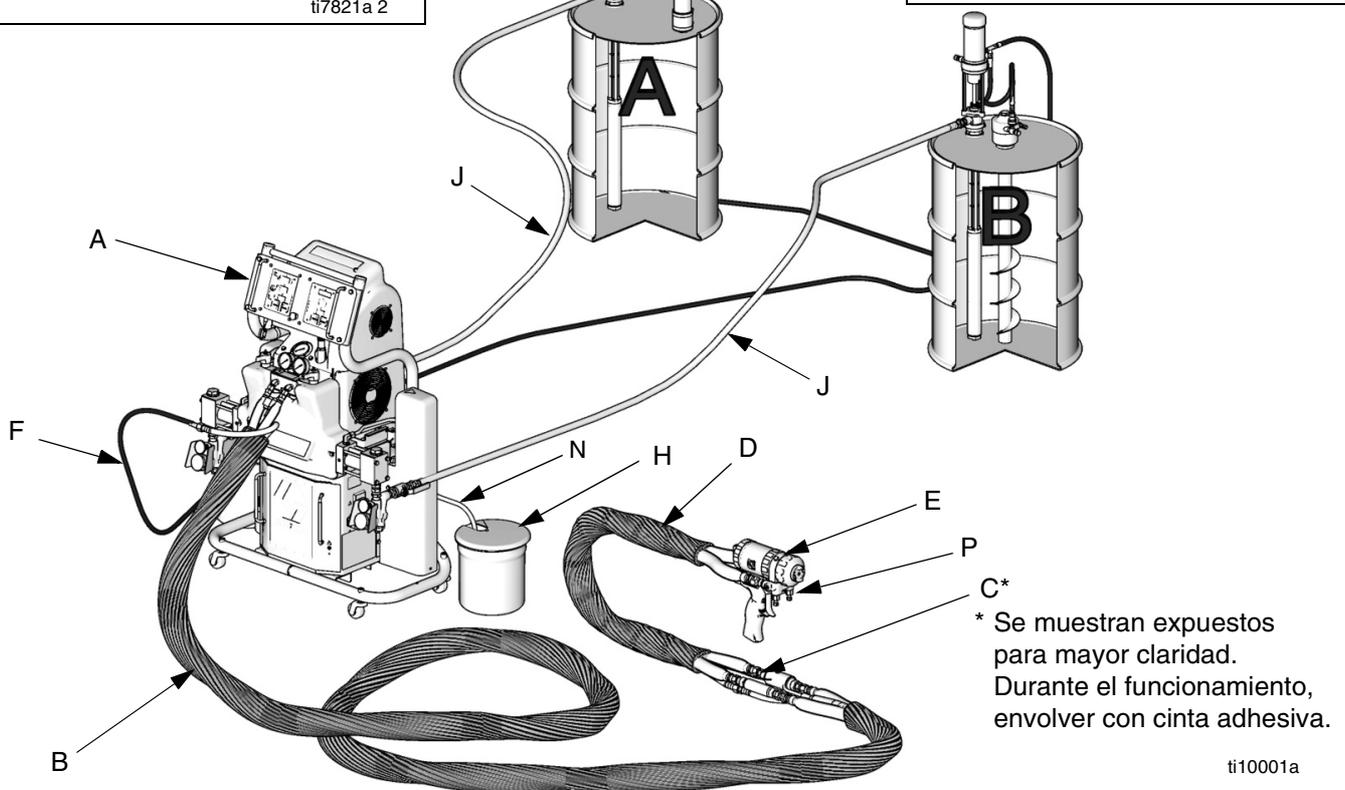
FIG. 2. Instalación típica, sin circulación
