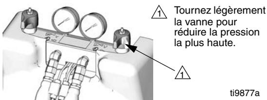
4. Pour tester si le défaut est sur le capteur ou la prise de la carte de commandes du moteur :
