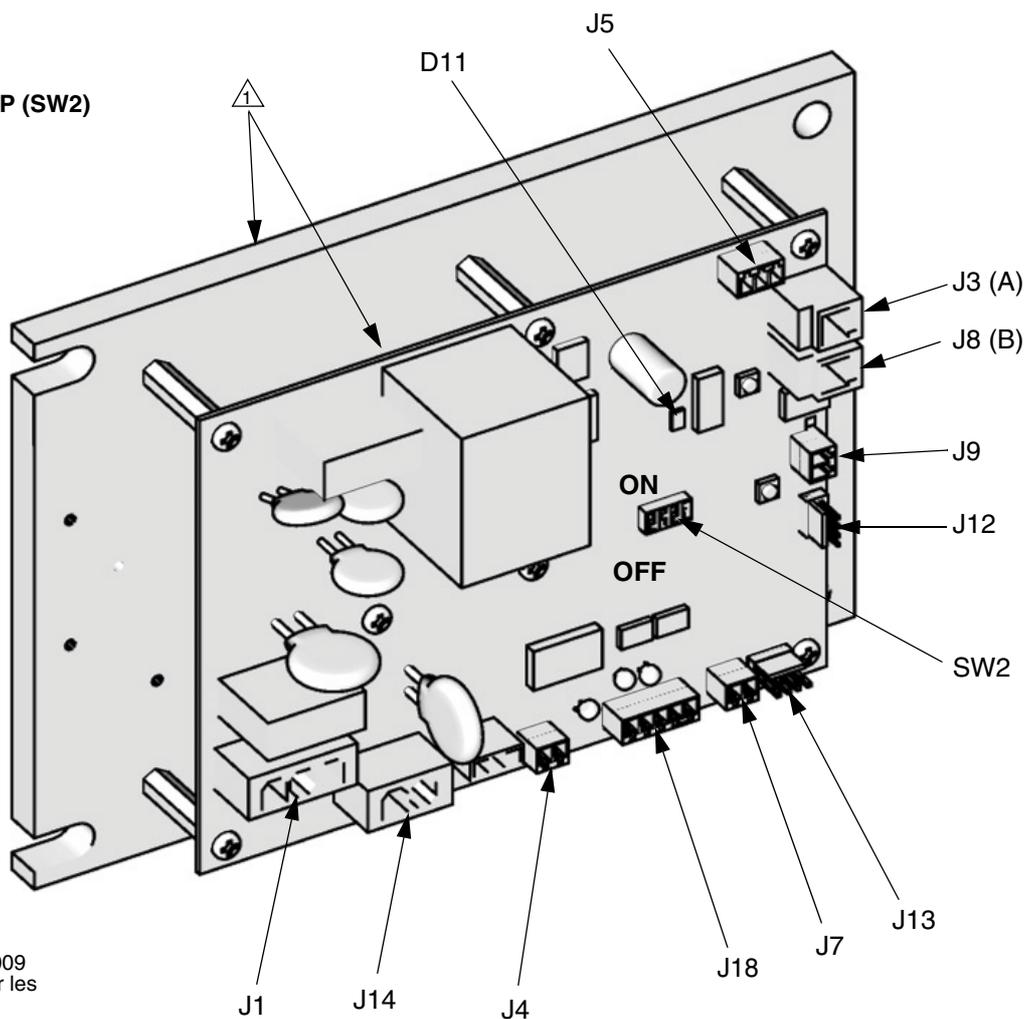
⚠ Appliquez du composant 110009 pour dissipateur thermique sur les surfaces cintrées.
